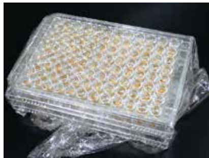
写真10 乾燥しないようにラップフィルムで被覆する。
