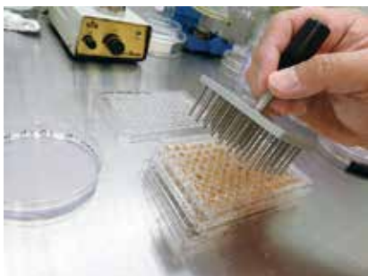
写真12 48ピン型のマイクロプレートレプリケータを用い、ウェル内の浸出液にピンを浸漬。
